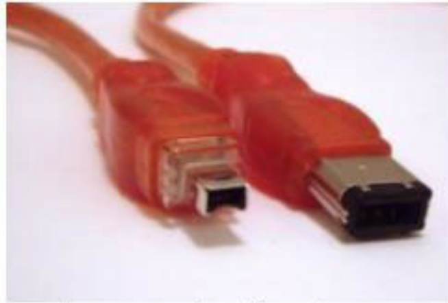
4-pinski (lijevo) i 6-pinski (dsno) FireWire konektori
